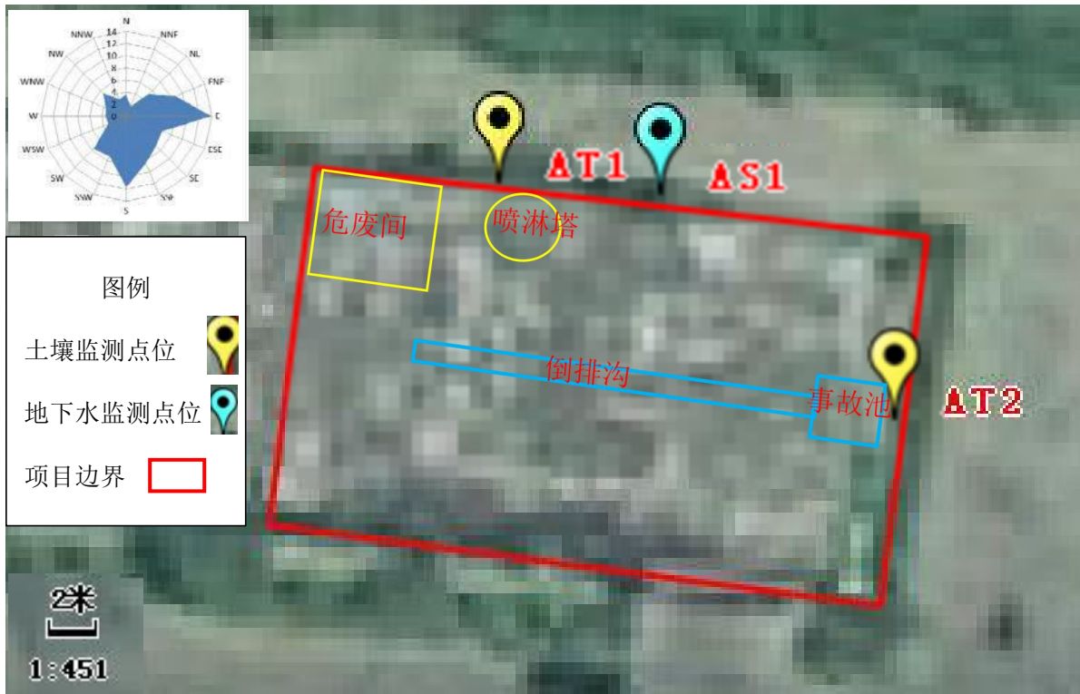
图 6-2 以单位总平面布置图为底图布点点位
